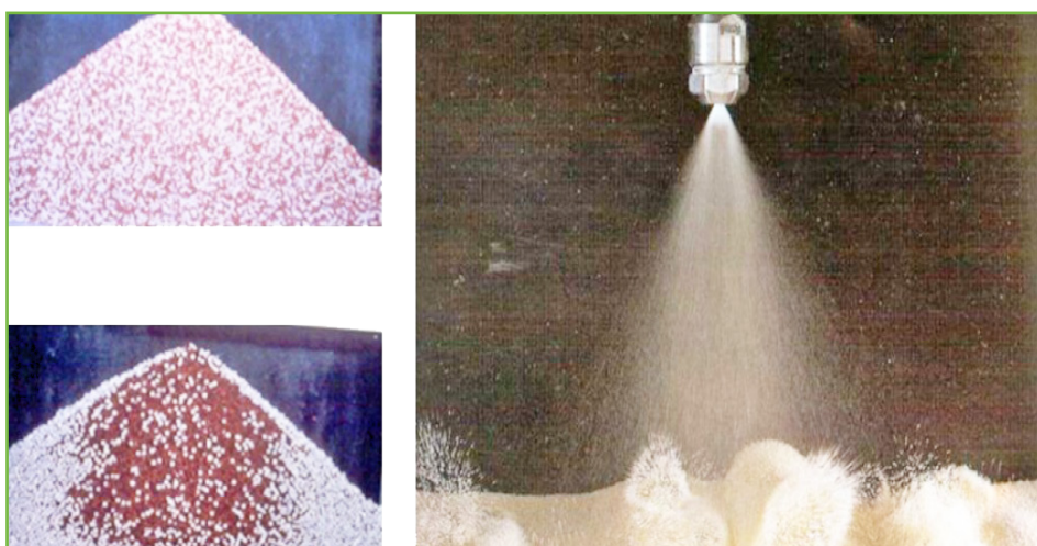
FIGURE 7. Mélange d'engrais avec risque de ségrégation (gauche) et incorporation d'oligo-éléments aux engrais granulés par enrobage (droite)
