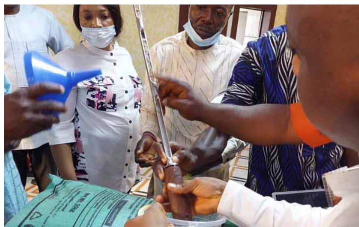
Les participants à une formation en cascade des inspecteurs d'engrais à Ebonyi, au Nigéria, apprennent la technique d'échantillonnage des sacs à l'aide d'une sonde « Missouri D » et d'un récipient collecteur.
